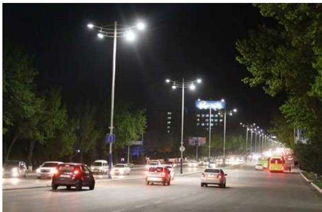
Рис. 4. Улицы районного значения, на которой установлены светильники на основе СД мощностью 130 Вт
