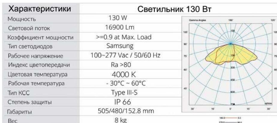
Рис. 2. Технические характеристики светильника *STREET META* мощностью 130 Вт
